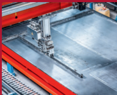
2. Einlegen der Schalung auf dem Schalungstisch
