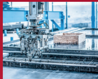
3. Einlegen der Bewehrung auf dem Schalungstisch
